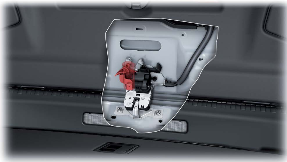
Аварийный привод крышки багажного отсека при складной спинке заднего сиденья
