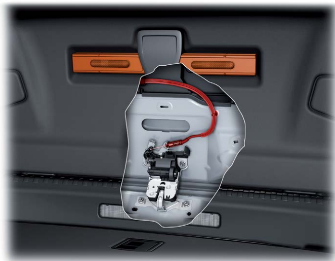
Аварийный привод крышки багажного отсека при фиксированной спинке заднего сиденья
